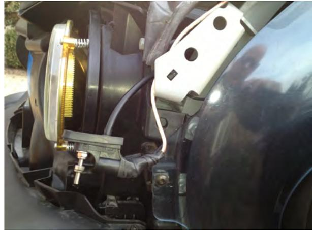
Hier kann das Antennenkabel nach innen geführt und der Antennenfuß befestigt werden.
