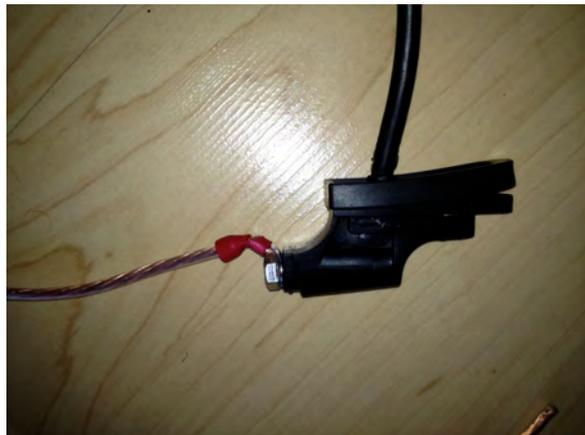
Anschließend wird der Schraubenkopf noch mit selbstverschweißendem Isolierband isoliert:
