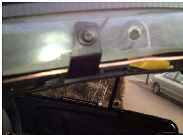
Kleiner Tipp: Die Montage wird einfacher wenn zusätzlich der linke Scheinwerfer ausgebaut wird, da man dann von innen mit dem Schraubendreher an den Antennenfuß kommt.
