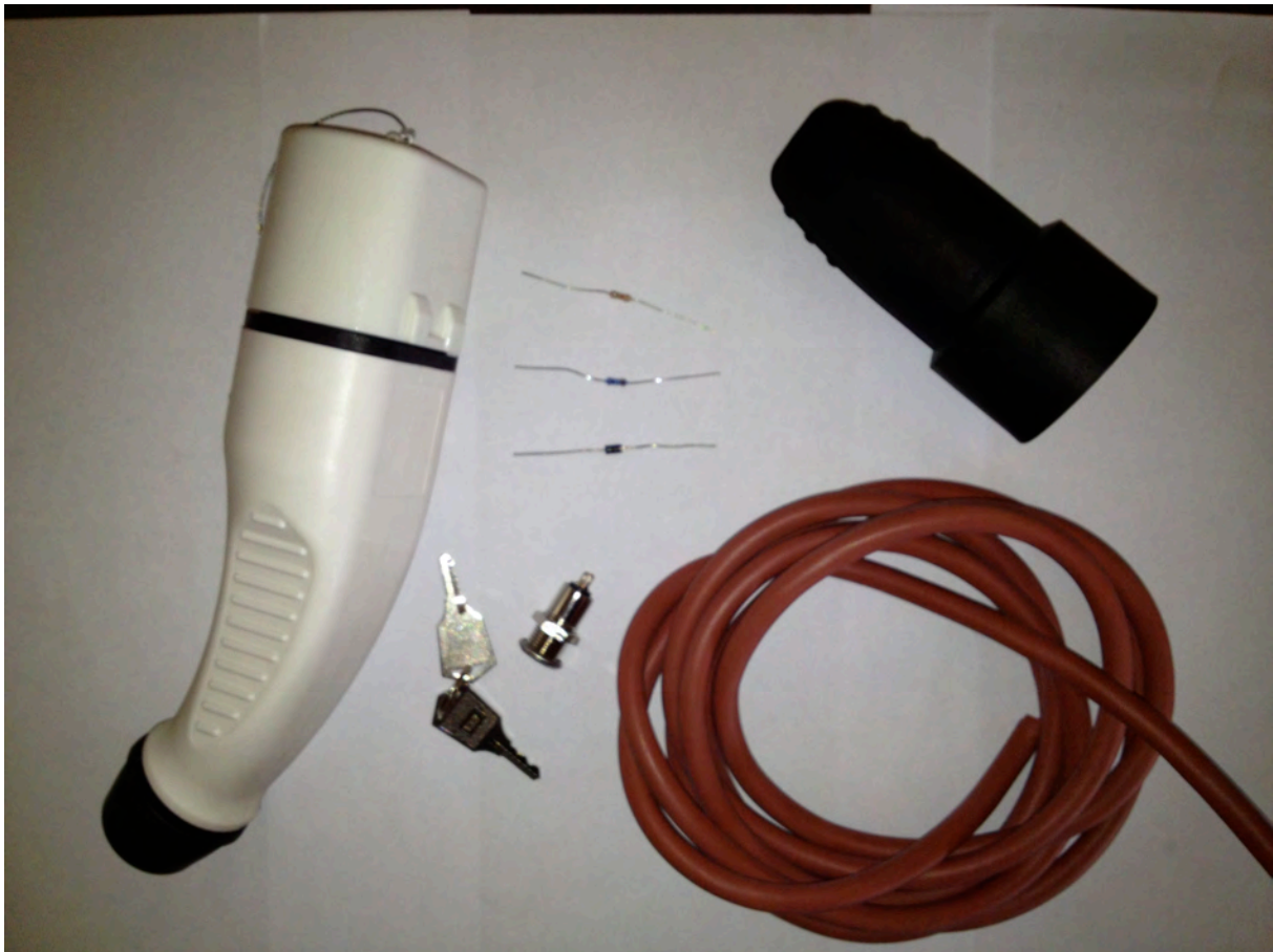
Abbildung 1: Notwendiges Material für den Adapterbau.
