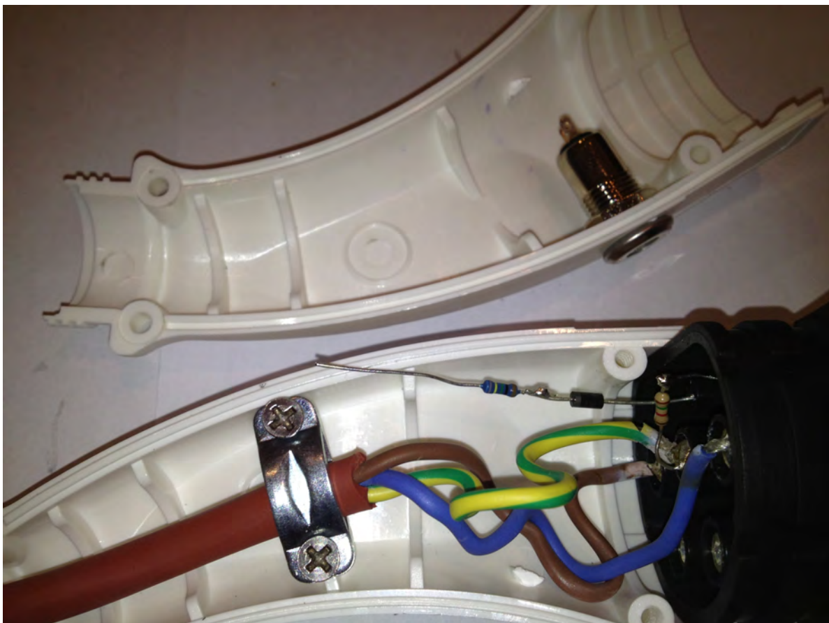
Abbildung 8: Eingebauter Schlüsselschalter und montierte Zugentlastung
