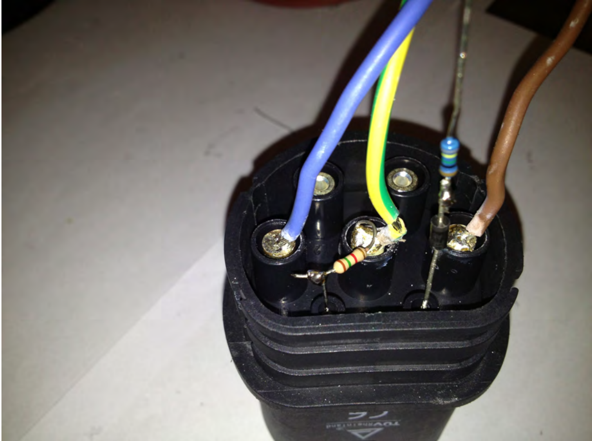
Abbildung 6: Steckerpins mit angelöteten Drähten, Widerständen und Diode
